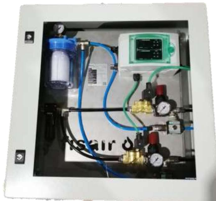
Abbildung 25: Vorderansicht des AtomSpray-Geräts AS-F1-Z mit epoxidharzlackiertem Rahmen
