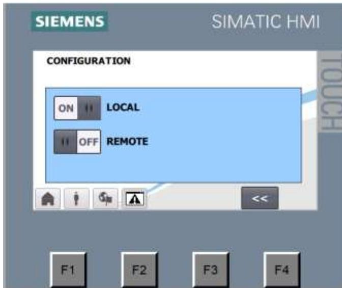
Bei Luftentfeuchtern mit Gateway für die Kommunikation können Sie für die Steuerung die Konfiguration Lokal oder Remote auswählen:
