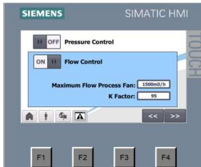
Bei der Option Regelung über Durchfluss werden die maximale Durchflussmenge des Prozessgebläses und der Wert des Faktors K eingestellt.
