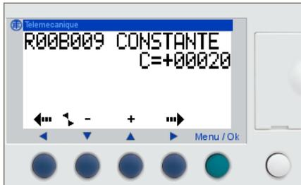
d) Um diesen Wert zu ändern, drücken Sie einmal ►, bis der Wert C = XXXX blinkt. Verwenden Sie die Tasten ▲ (+) und ▼ (-), bis der gewünschte Wert erreicht ist. In diesem Fall 75% Öffnung. Drücken Sie die grüne Taste (Menü/Ok), um die Änderung zu bestätigen. (Geben Sie einen Wert zwischen 0-100 ein).
