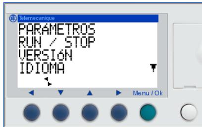
a) Drücken Sie im Überwachungsbildschirm „manueller Modus“ oder „automatischer Modus“ einmal die grüne Taste „Menü/Ok“; die nächste Anzeige erscheint mit dem blinkenden Wort "PARAMETER".
