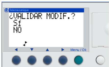
e) Durch Drücken der Taste Menü/Ok wird diese Anzeige mit blinkendem „Ja“ angezeigt. Drücken Sie erneut dieTaste Menü/Ok, um die Änderung zu bestätigen.
