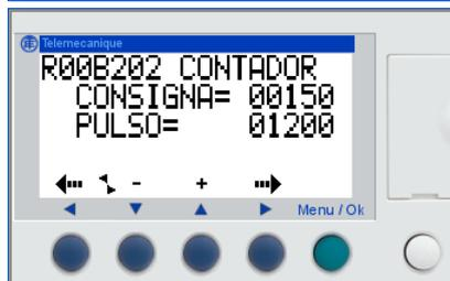
d) Um diesen Wert zu ändern, drücken Sie einmal ►, bis der Wert SOLLWERT= 00150 blinkt. Verwenden Sie die Tasten ▲ (+) und ▼ (-), bis der gewünschte Wert erreicht ist. Drücken Sie die grüne Taste (Menü/Ok), um die Änderung zu bestätigen. Führen Sie auf die gleiche Weise die Entleerungsdauer (PULSE) aus.
