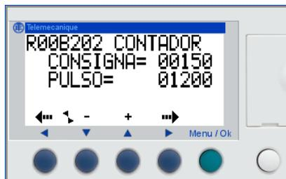
c) Um das Modul F00B:202 aufzurufen, verwenden Sie die Tasten ▲ (+) und ▼ (-), bis dieses Modul erreicht ist. Sie sehen, dass 150 Zyklen und 1200 dS (2 Minuten) programmiert sind.
