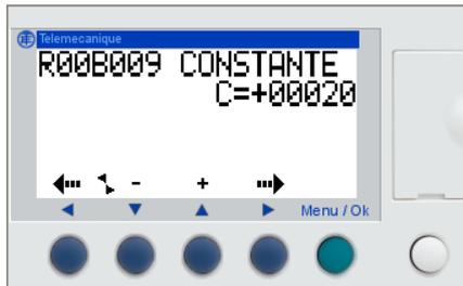
c) Um das Modul R00B: 009 aufzurufen, verwenden Sie die Tasten ▲ (+) und ▼ (-), bis dieses Modul erreicht ist. Sie sehen, dass er auf 20% programmiert ist.
