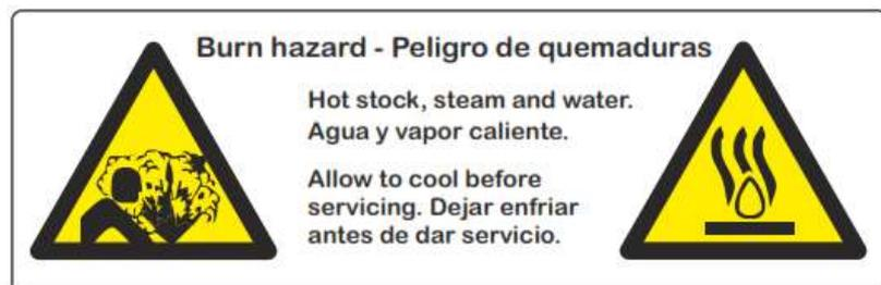
Dieser Dampfbefeuchter hat Oberflächen, die extrem heiß werden. Tankwasser, Rohrleitungen und Dispersionsanlagen können 100 °C erreichen.
